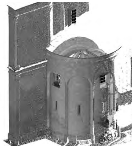
1-2. Minervino. Chiesa di San Michele Arcangelo, interno dell'abside e viste assonometriche delle "nuvole di punti"; viste superiore e assonometrica delle "nuvole di punti" unite delle absidi delle chiese di San Michele Arcangelo a Minervino e di San Nicola a Corsi (Lecce).
