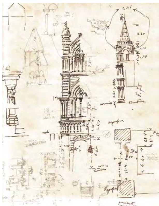
3. A. Zanca, rilievo di una delle torri angolari del duomo di Palermo, s.d. (Palermo, FAZ).
